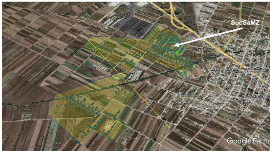
Figura 10. Distribución de la red de puntos adquiridos por prospección magnética terrestre
